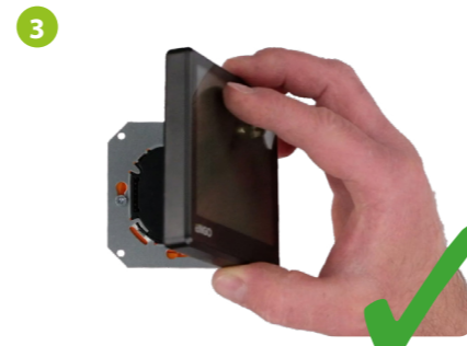
Nasunij przód regulatora na jego tylną część. Włącz zasilanie. Regulator jest przygotowany do pracy.
