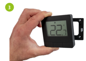
Pričvrstiti termostat na ploču.
