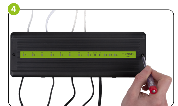
Después de asegurarse de que todos los cables son correctamente conectados, instale la tapa superior y conecta la barra con la alimentación de 230 V - el diodo LED rojo de alimentación "Power" se ilumina.
