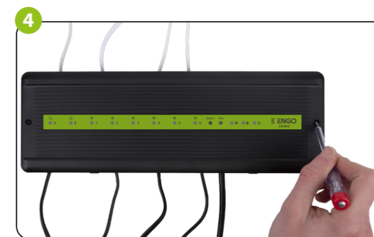
Įsitikinus, kad visi laidai yra prijungti tinkamai, reikia uždėti viršutinį dangtelį ir prijungti plokštės 230 V maitinimą – įsijungs maitinimo raudonas šviesos diodas.
