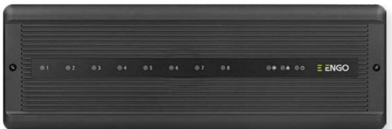
Upravljačka traka ECB08M230 glavni je element upravljačkog sustava podnog grijanja. Ima ugrađene module koji kontroliraju izvore topline (beznaponski relaj) i pumpe (230V AC). Upravljačka kutija omogućuje upravljanje 8 različitih zona. Opremljena je 230V AC izlaznim naponom za aktuatore. Utični blokovi terminala omogućuju brzo i praktično povezivanje ožičenja. Upravljačka kutija je dizajnirana za rad s NC (normalno zatvorenim) aktuatorima/pogonima.
